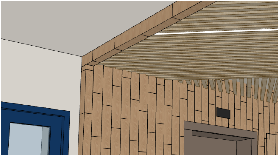
Подшивка потолка ГКЛ и облицовка Керамогранитом ЛИСТОНЕ SG402100N БЕЖЕВЫЙ 9.9Х40.2 Низ плитки на отм. +2580 мм от ур.ч.п.
